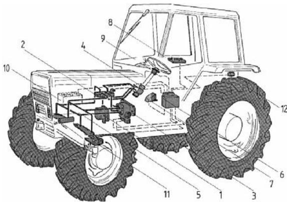
Fig. 2: The Claas autopilot (Keicher and Seufert, 2000)
